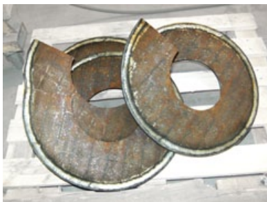
Schneckenwendel mit Kantenpanzerung-PTA
